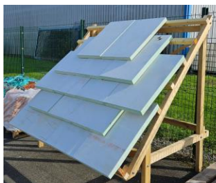
Piste abandonnée : Echantillons de bardage à partir de pale d'éolienne
