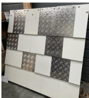
Piste finale : Prototype de bardage à partir de tressa et aluminium coupé en bardage
